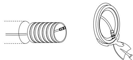
3 Забетонируйте монтажную чашу в углублении
