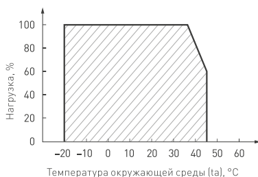
Рис. 2. Максимальная допустимая нагрузка, % от мощности источника
