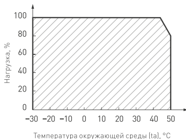
Рис. 2. Максимальная допустимая нагрузка, % от мощности источника
